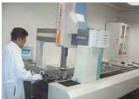
Calibración de bloques patrón largos
