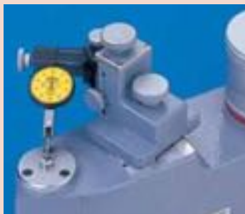
Calibrando un indicador de carátula tipo palanca
