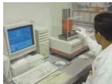
Calibración de bloques patrón cortos
