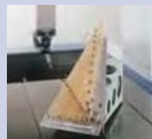
Dispositivo de calibración para CMM utilizando patrones de vidrio con expansión térmica virtualmente cero
