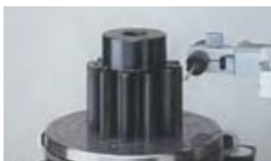
Medición en pieza con discontinuidades
